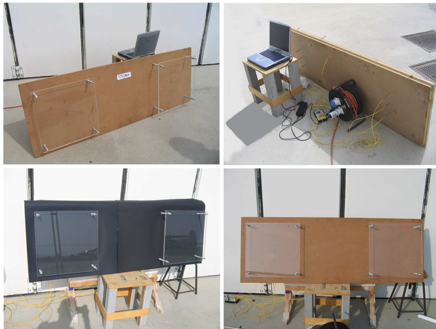
Figura 5.2: Dispositivi sperimentali per la simulazione del campo termico e dei flussi ventosi.
