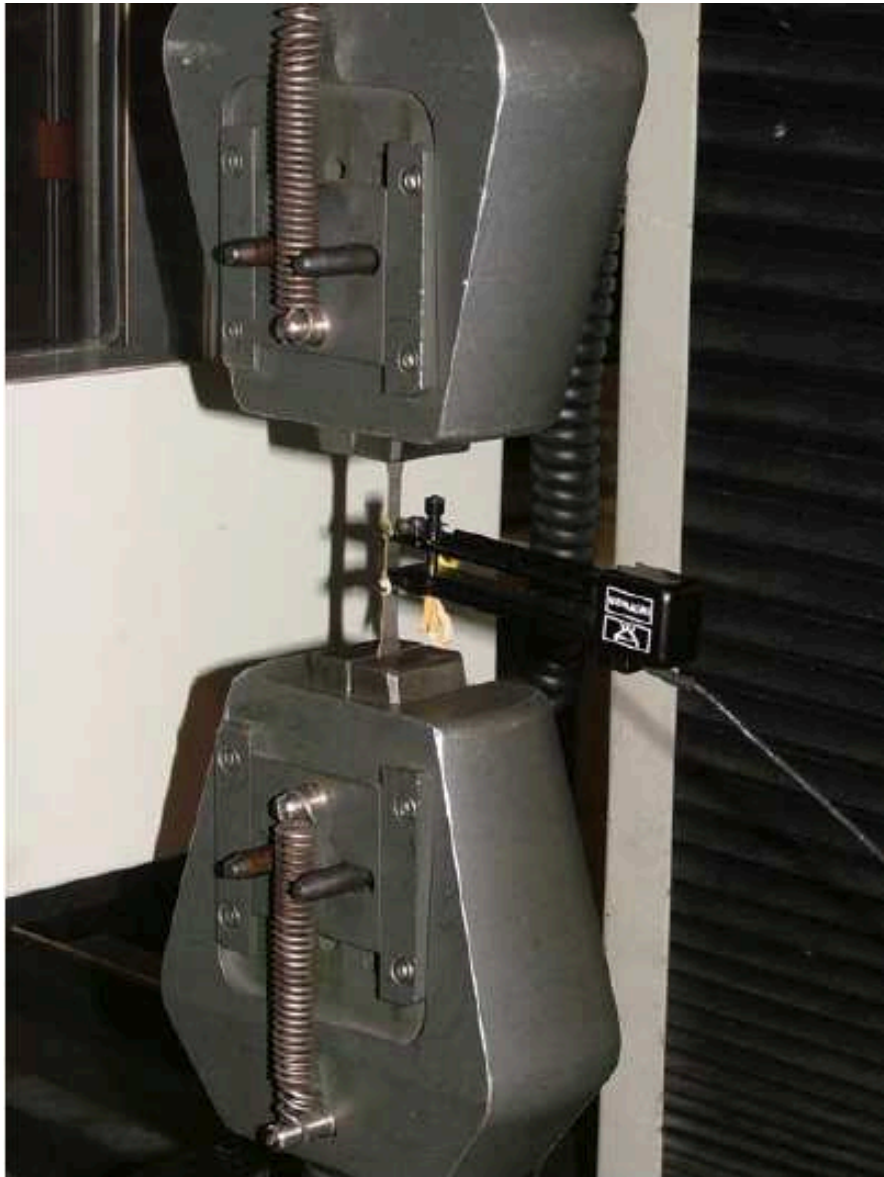
Figura 3.18: Le due estremità del provino vengono bloccate per mezzo di due ganasce e lungo il suo tratto utile di 32\text{ mm} viene fissato un estensimetro a coltelli.
