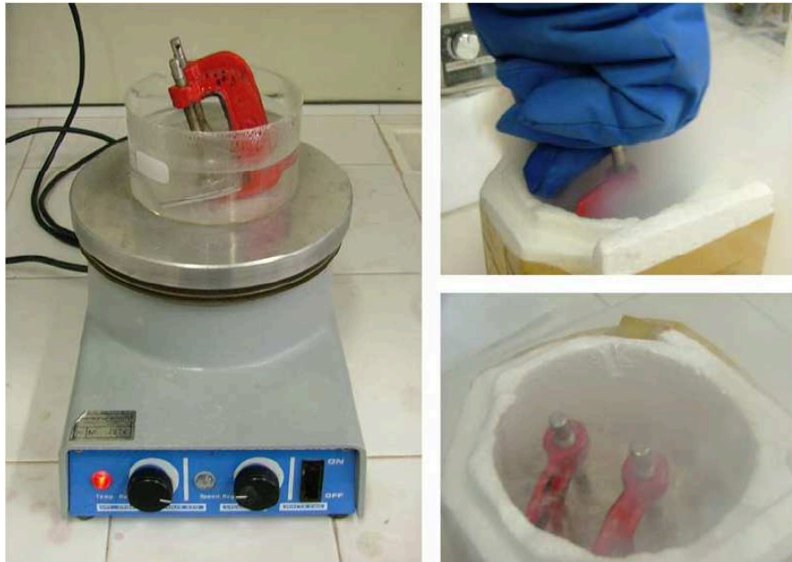
Figura 3.36: Immersione del dispositivo, vincolato rigidamente nella configurazione planare tra due piastre bloccate da morsetti, in acqua bollente ed in azoto liquido.
