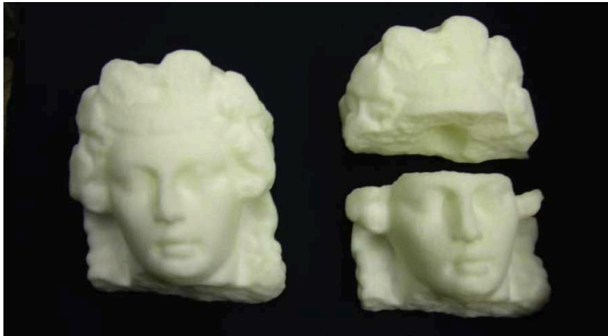
Figura 6.3: Modello fisico del reperto integro e dei due frammenti con le relative sedi predisposte per l'inserimento del dispositivo.
