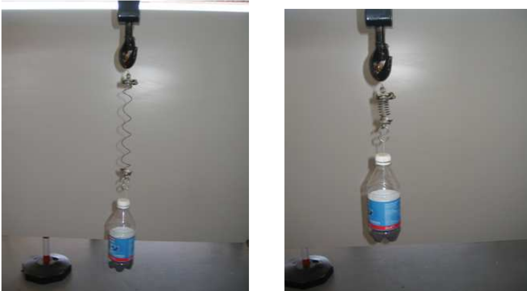
Figura 6.5: Sequenza di riscaldamento della molla che, accorciandosi, solleva un peso massimo di 500 gr .
