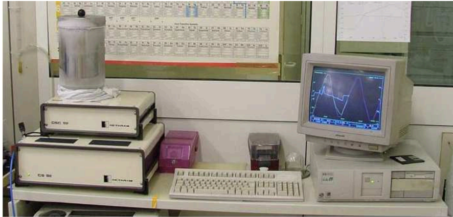
Figura 3.4: Apparecchiatura Setaram® DSC 92 per la calorimetria differenziale a scansione, in dotazione presso il Laboratorio di Microstrutture del DIMTI dell'Università di Trento. In alto a sinistra si può riconoscere il dewar utilizzato per il raffreddamento, caricato con azoto liquido, al cui interno trova alloggio la camera portacampioni con i due crogiuoli.
