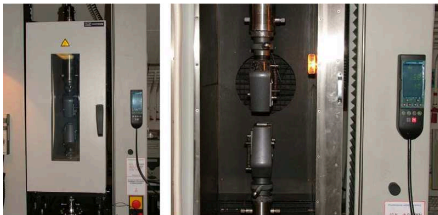
Figura 3.21: Camera termostatica mod. 3119, attraverso la quale è possibile condurre prove di trazione alla temperatura desiderata. Un indicatore digitale segnala la temperatura della camera.
