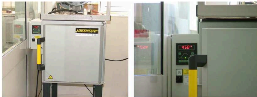
Figura 3.3: Forno Nabertherm ® 30/85HA 400, utilizzato per il trattamento termico dei provini in NiTiNOL. Nel particolare è visibile il pannello di controllo del forno, con il quale è possibile programmare i parametri del trattamento termico che si desidera condurre.
