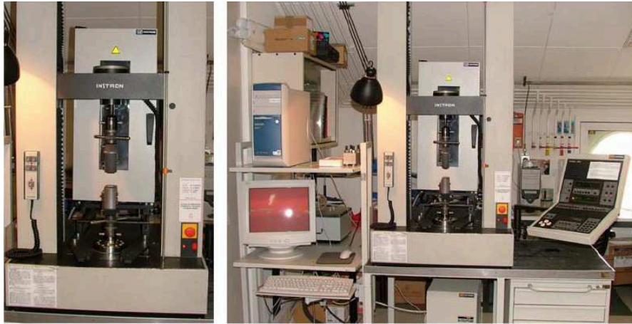
Figura 3.12: Macchina Instron ® 4502 per l'effettuazione delle prove meccaniche di trazione, in dotazione presso il Laboratorio di Polimeri e Compositi del DIMTI dell'Università di Trento.
