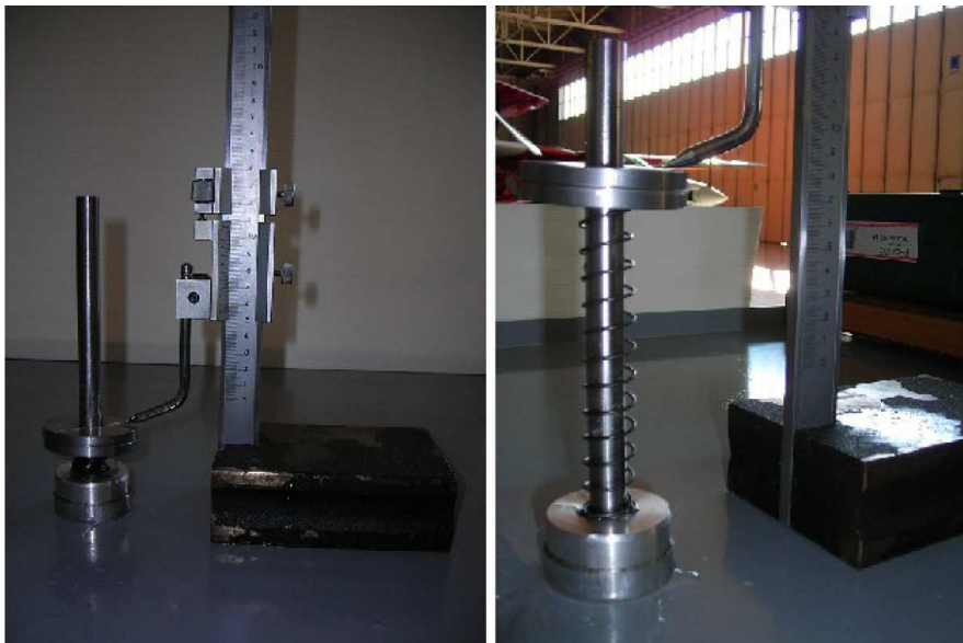
Figura 5.9: Per misurare gli allungamenti e gli accorciamenti è stato utilizzato un truschino che è uno strumento che solitamente viene utilizzato nella tracciatura di pezzi meccanici. È formato da una base spianata su cui è fissata un'asta lungo la quale è libero di muoversi un graffietto, la cui punta determina la posizione della linea o del punto che si intende misurare.
