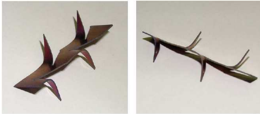
Figura 3.32: Ancoraggio in NiTiNOL nella configurazione deformata, ottenuta a seguito del trattamento termico a 400\text{ }^{\circ}\text{C} per 30 minuti. È possibile riconoscere sulla superficie del metallo termicamente trattato una sottile patina dovuta all'insorgenza di fenomeni di natura ossidativa che hanno coinvolto la lega durante la permanenza ad alta temperatura.
