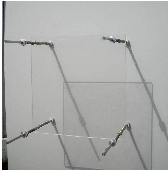
Figura 5.7: Immagine del dispositivo molla-contromolla per la movimentazione di lastre.
