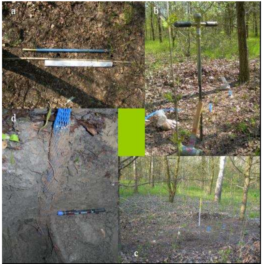
Figura 13 Igc di suolo C4 nel bosco di Nonantola. a) le “calze” di rete e i controlli; b) la messa a dimora; c) la posizione; d) l'estrazione.
