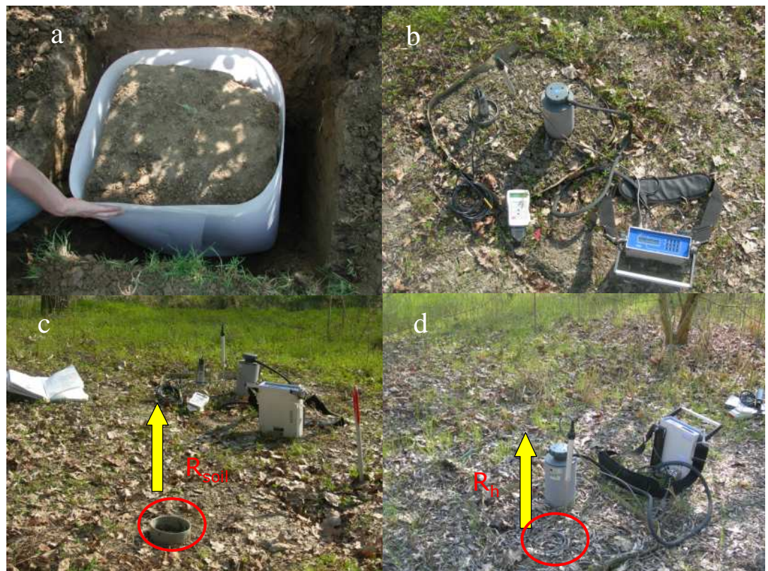
Figura 10 a) Preparazione dei trenched plots e strumentazione per la misura dei flussi. a) Zolla esclusa dalla presenza di radici vive; b) Trenched plot con collari e cameretta SRC 1 collegata all'EGM4 PP SYSTEMS e Sensore Teta Probe MI 2x Delta-T Devices; c) Collare di misura di R_{soil} ; d) Collare di misura di R_h
