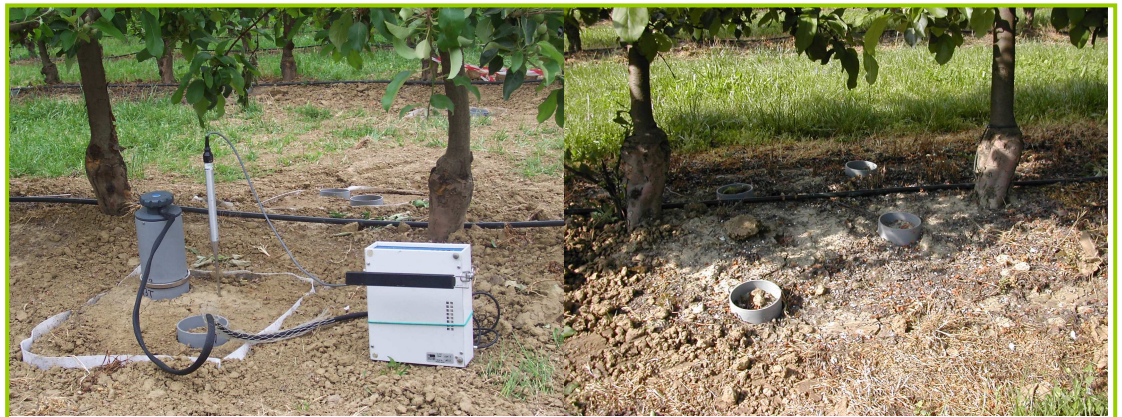
Figura 16 Misura della respirazione eterotrofa nei trenched plots (a) e collari di controllo (b).
