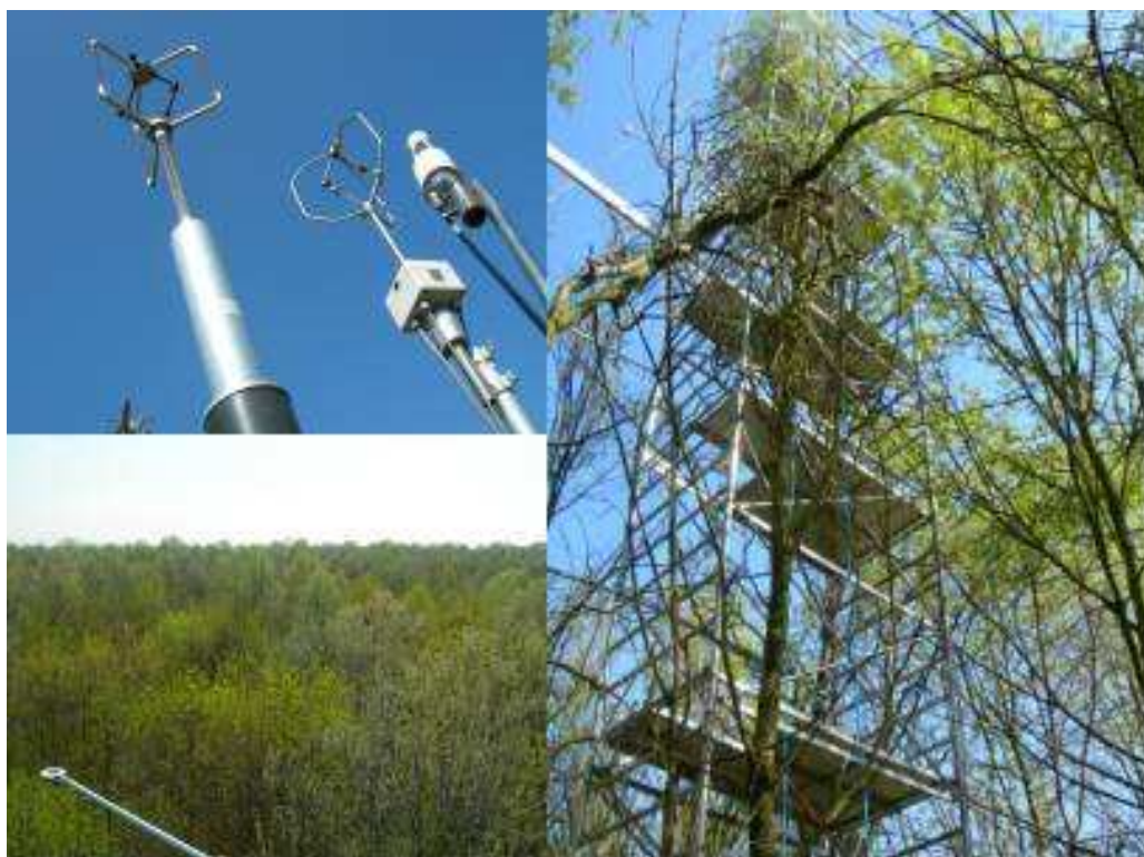
Figura 11 Particolari della torre Eddy nella primavera 2006. In senso orario da sinistra: gli anemometri direzionali e l'analizzatore di gas, la torre e il bosco di Nonantola visto dalla torre.
